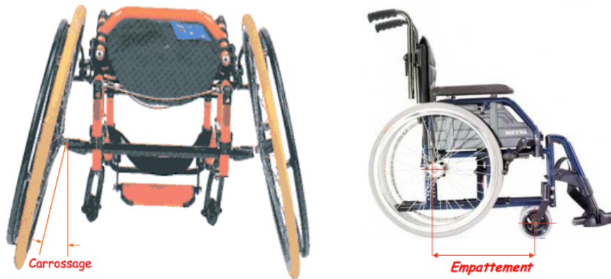
Figure N°23 : Illustration d'un carrossage des roues arrières (à gauche) et de l'empattement (à droite)
