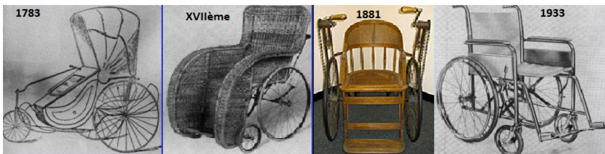
Figure N°21: Illustration de l'évolution des FR: de gauche à droite : chaise mécanique pour invalide du 18 ème siècle, FR en osier au 19 ème siècle et FR pliable en acier tubulaire au 20 ème siècle.
