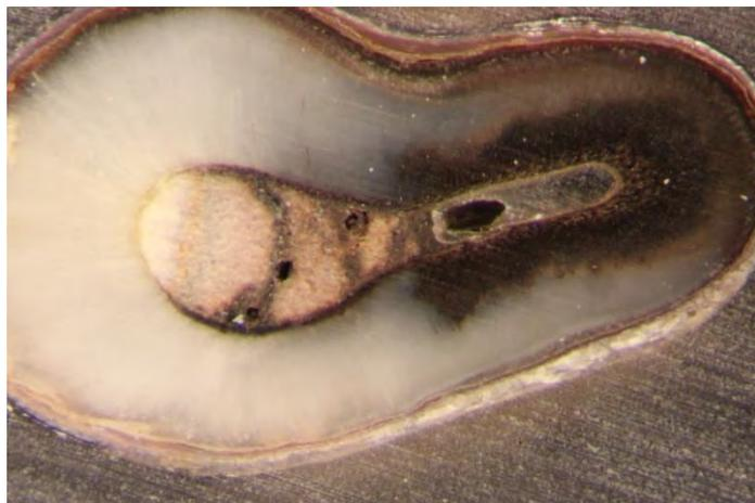
Figure n°21 : Photographie de la coupe 1-8-1 sous microscope optique (x16) – Score 3
