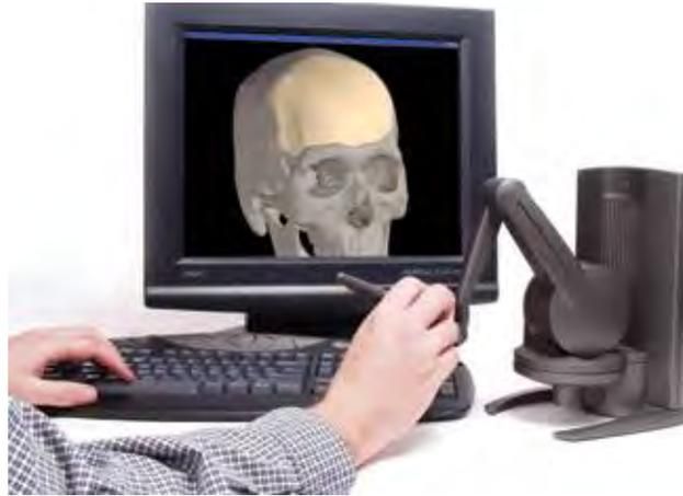
*Figure 49 : le dispositif Phantom® Desktop haptic interface (SensAble Technologies 2016).*
