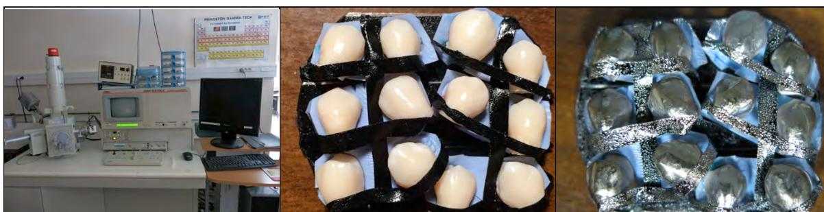
**Figure 30 : MEB JEOL JSM-5310 LV INSA Toulouse. Echantillons avant métallisation. Echantillons après métallisation (CP)**
