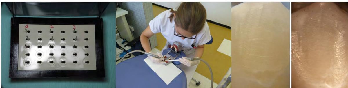
**Figure 26 : Boitier Stoner®, dépose de la colle avec la fraise diamantée, photographie post nettoyage à la fraise diamantée, prise en mode macro et prise avec une loupe binoculaire x6,4 (CP)**
