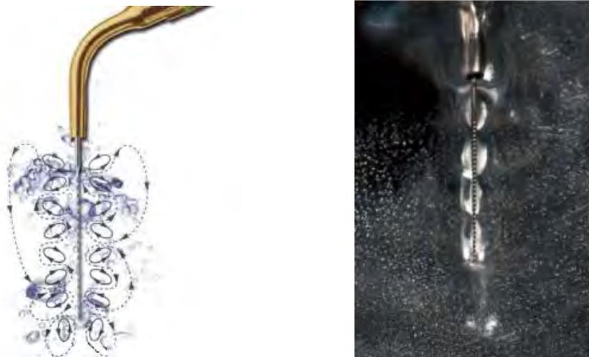
Figure 15 : Fonctionnement de l'Irrisafe<sup>®</sup> [52]
