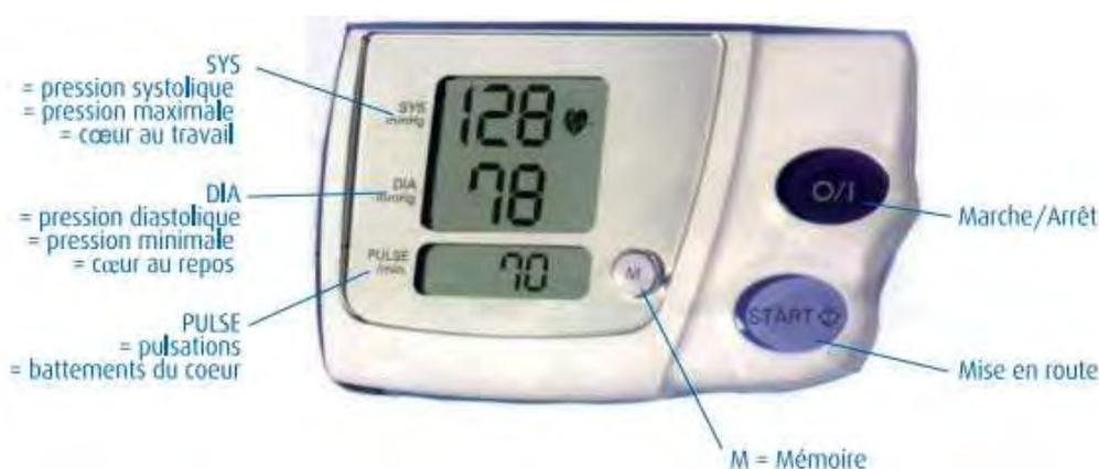
Figure 36 : Schéma d'un autotensiomètre avec les principaux boutons d'utilisation
