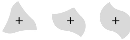
Figure 12 : Schéma d'évolution de la section du One Shape® de la zone apicale (à gauche) à la zone coronaire (à droite)
