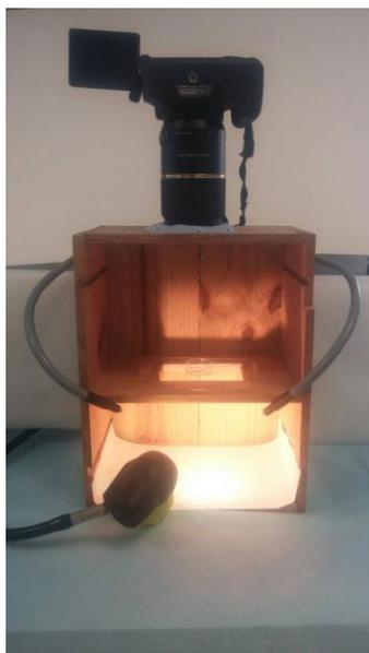
**Figure 37 : Moyen d'observation avec rétro éclairage**
