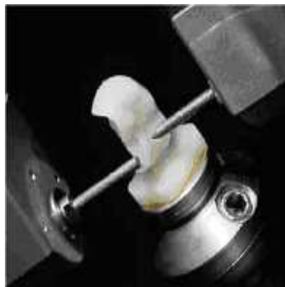
Figure 17. Usinage d'un onlay par le CEREC III
