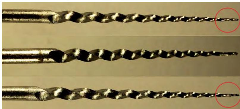
Figure 28 : Dé-spiralisation de la lime D3
