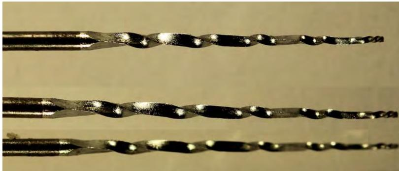
Figure 30 : *Fracture de la partie apicale de la lime DR2*
