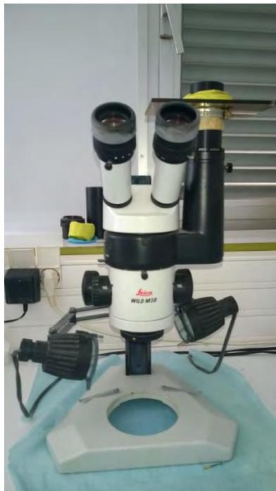
Figure 15 : *Microscope optique binoculaire*
