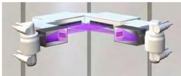
Figure 13 : Bras en C contenant tubes et détecteurs
