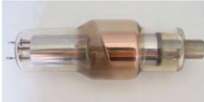
Figure 6 : Tube à rayons X
